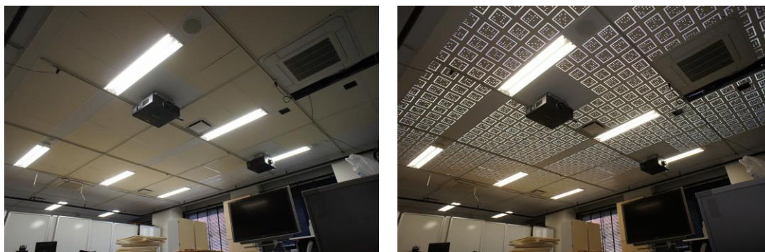
図 17 不可視マーカを設置した様子(左)、フラッシュ撮影した不可視マーカ(右)
