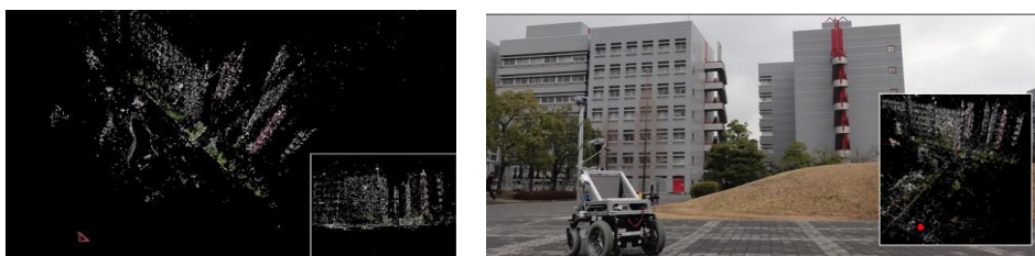
図 55 3 次元特徴点地図を用いたビューシーケンスナビゲーション
