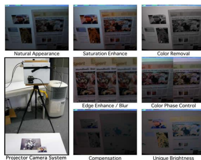
図 38 カメラ-プロジェクタフィードバック系による見えの制御
