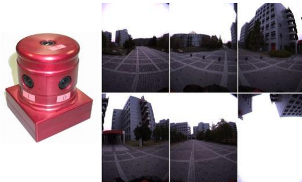
図 18 全方位型マルチカメラシステム Ladybug と入力画像の一部
