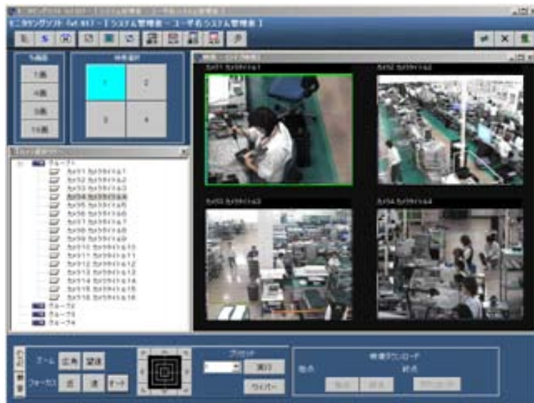
図 2 システムカメラを用いた製造現場の作業状況映像記録システム [2]
