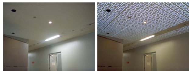
(a) 不可視マーカ (フラッシュ無しで撮影) (b) 不可視マーカ (フラッシュありで撮影) (a) Invisible markers without a flash. (b) Invisible markers with a flash.
