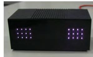
Fig. 8 距離画像センサ<sup>24)</sup>
