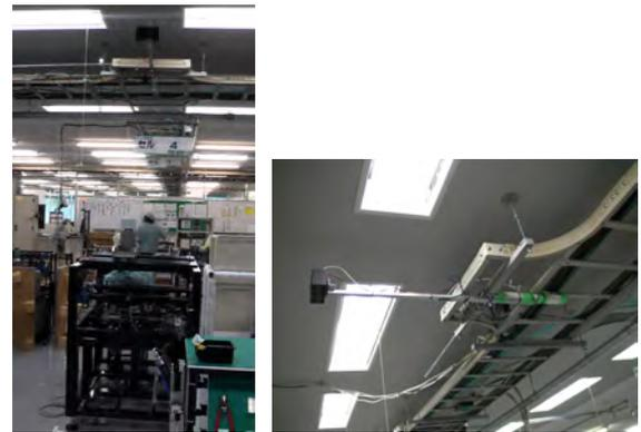
(a) 全体の様子 (b) 距離画像センサの設置の様子
