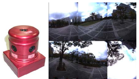
図 3 データベース構築に用いた全方位型マルチカメラシステムと入力画像の一部
