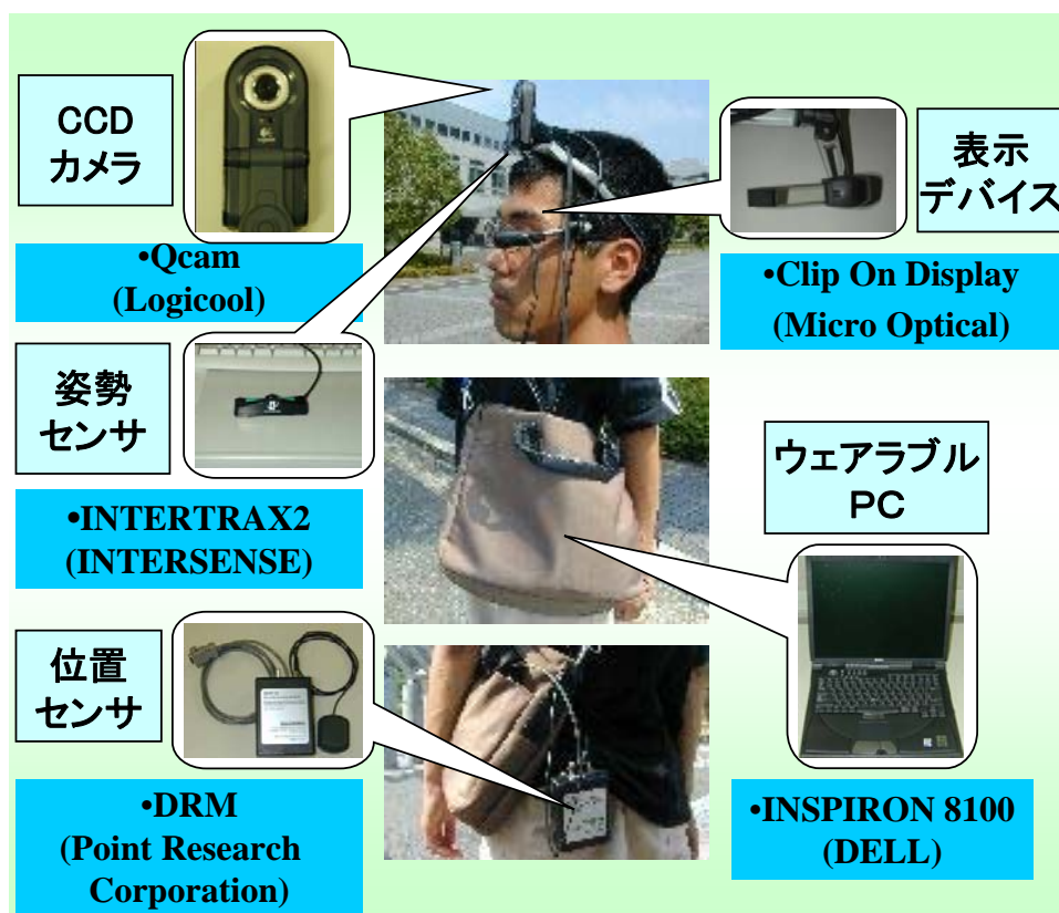
図 21 ウェアラブル拡張現実感システムの機器構成
