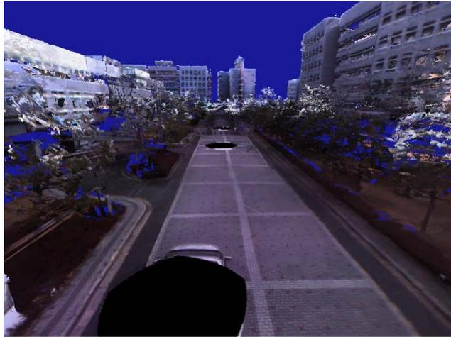
図1 レーザレンジファインダを用いた三次元モデルにおける欠損の例 [3]
