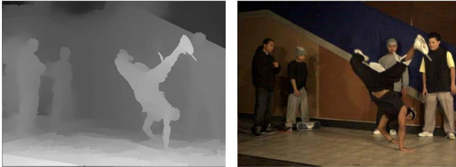
図 7 セグメンテーションベースドステレオにより推定された奥行き画像（左）と自由視点画像例（右） [28]
