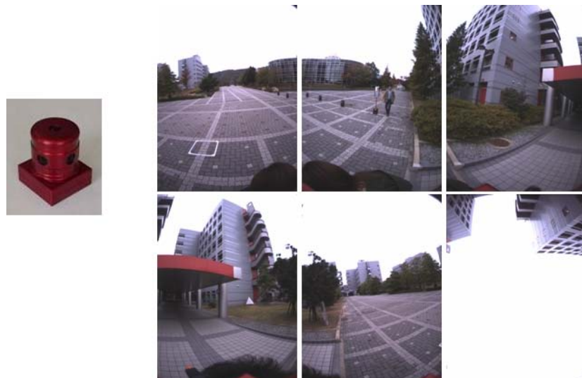
図 20 全方位型マルチカメラシステムとデータベースの構築に用いた全方位動画像の一部
