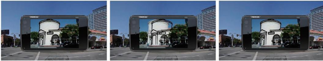
図 6 事前生成型 AR の位置ずれ比較（左側：理想重畳画像，中央：センサベース AR，右：事前生成型モバイル AR） [23]
