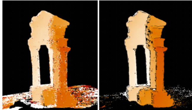
図 8 エネルギー関数最小化による奥行画像上のノイズ除去. (左) ノイズが生じた奥行画像 [14], (右) ノイズ除去結果 [18]
