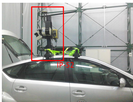
図 15 本研究で使用した IP-S2 を搭載した実験車両
