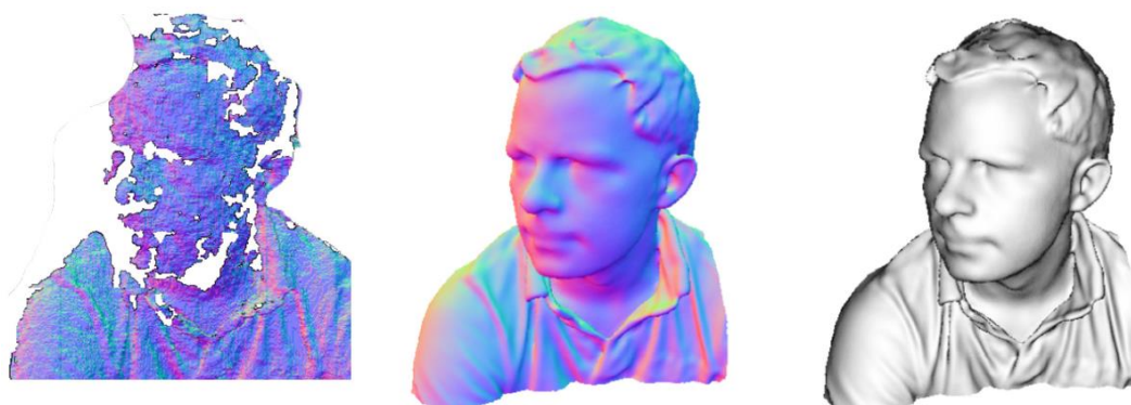
図 7: デプス画像を用いた手法により復元された剛体物体の 3 次元形状の例 [31]
