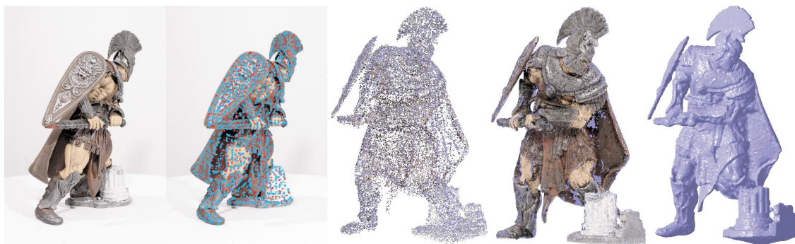
図 6: RGB 画像を用いた手法により復元された剛体物体の 3 次元形状の例 [9]
