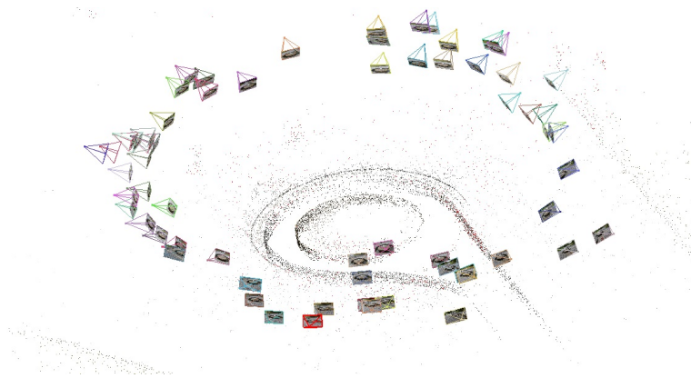
図 21 VisualSFM によるカメラ位置姿勢と推定された三次元位置 (噴水のシーン)
