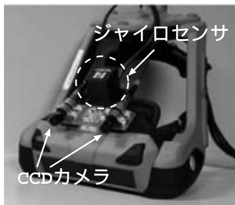
図 19 ジャイロセンサとステレオカメラを組み合わせたビデオシースルーステレオ HMD
