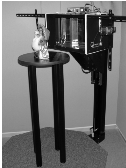
(a) 全周計測レンジファインダ Cyberware 3030RGB
