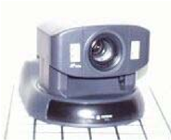
図 11 首振りカメラ (SONY EVI-D30)
