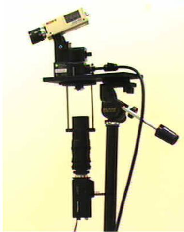
図 5 全方位画像センサと回転カメラを組み合わせた監視システム [19]
