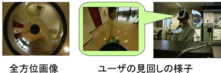
図 4 全方位画像センサを用いたテレプレゼンスシステム
