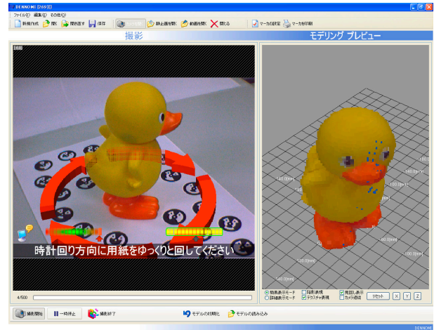
図3 撮影指示およびプレビュー表示のインタフェース Fig. 3 Interface of indication of camera movement and preview.
