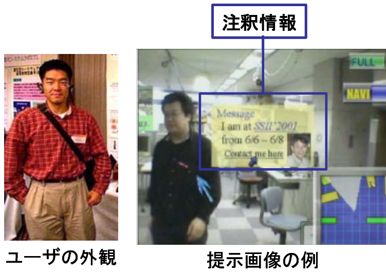
図 2 VizWear[16] で提示される注釈情報の重畳画像の例
