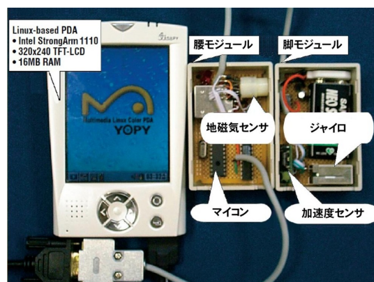
図 7: 自律計測による位置・姿勢推定システム (Konishi ら [22])
