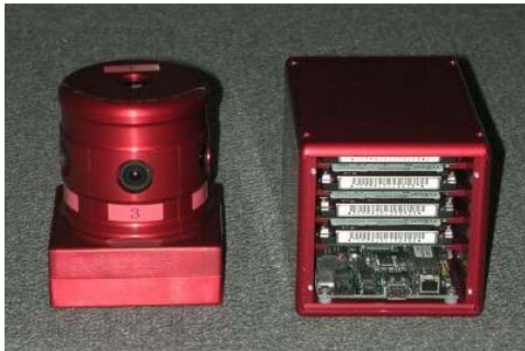
図 17 全方位マルチカメラシステム (Ladybug)
