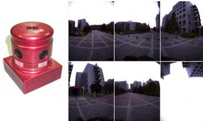
図 10 全方位型マルチカメラシステム Ladybug と撮影された全方位画像
