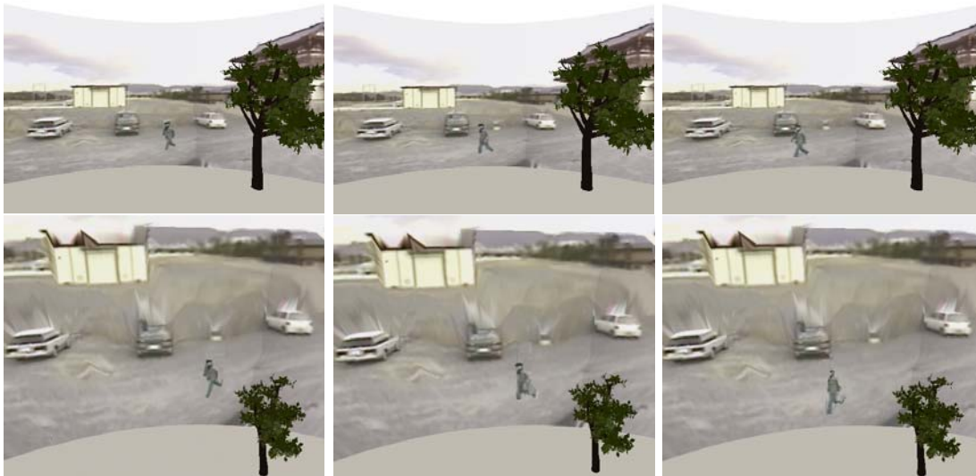
図 26 全周実環境モデルへ動物体領域を配置した様子 (上：撮像地点位置，下：鳥瞰図)
