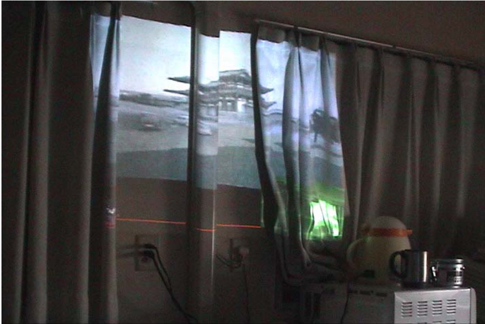
図 56 幾何補正無し投影結果
