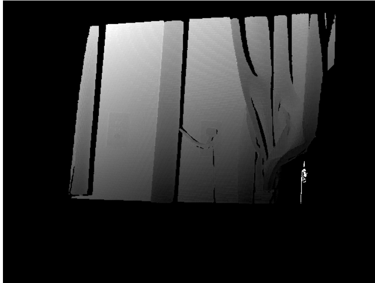
図 53 投影面の 3 次元復元結果（奥行き画像表現）
