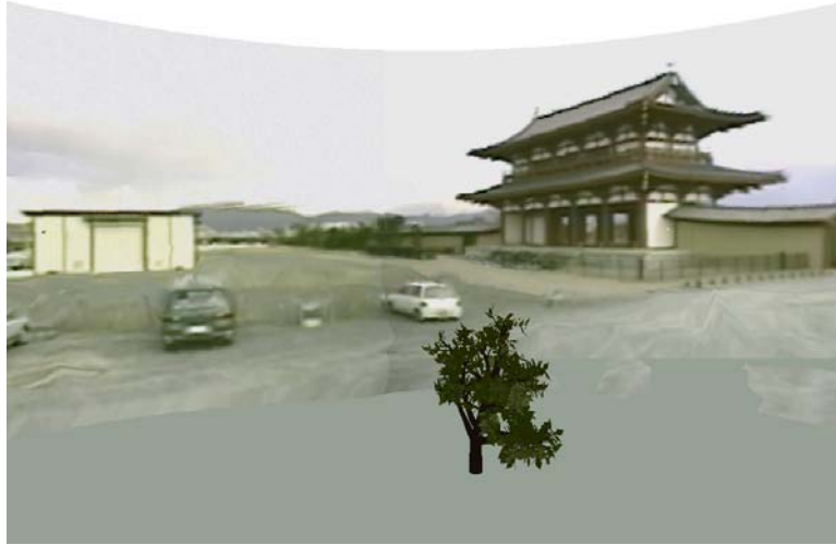
図 17 全周実環境モデルと仮想物体（樹木 CG モデル）の合成結果
