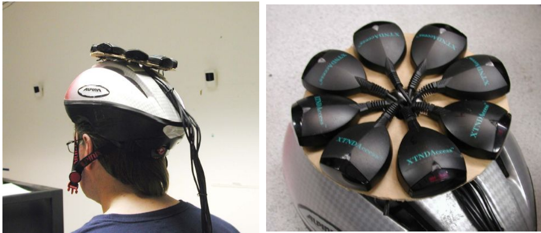
図 3 Hallaway らの赤外線センサによる位置・姿勢計測システム [7]
