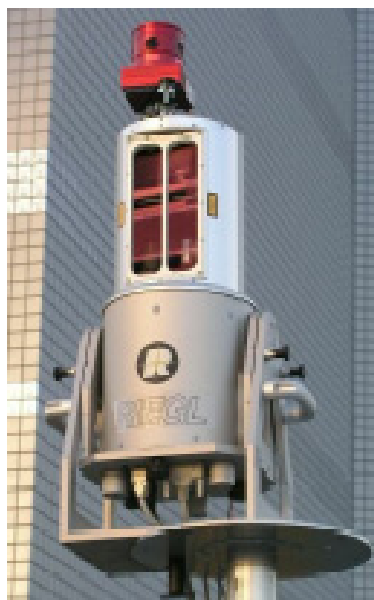
図 3 全方位レンジファインダ(下)と全方位カメラ(上)
