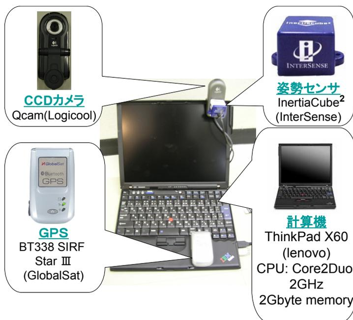
図 30 注釈提示のために用いたモバイル AR システムの機器構成
